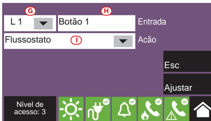
**EN12094-1:** Para garantir a conformidade com a norma EN 12094-1, as entradas utilizadas deverão ser I/O na central ou entradas supervisionadas em módulos de loop (como por exemplo o módulo EM312SR). Não é possível conectar mais de 32 dispositivos a cada um dos terminais de entrada ou saída seleccionados. É necessário fornecer a entrada associada à funcionalidade "Extinção Manual" (as outras são opcionais).
