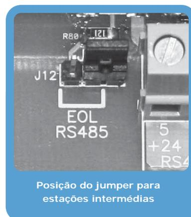
Figura 27 - Placa SmartLetUSSee - posição do jumper
