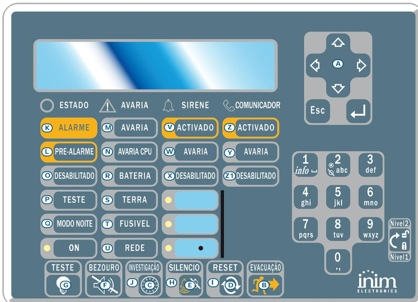
Figura 9 - Vista frontal do repetidor
